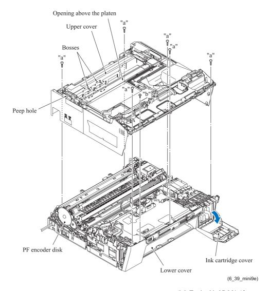
"a": Taptite, bind B M4x12 "b": Taptite, cup B M3x10
